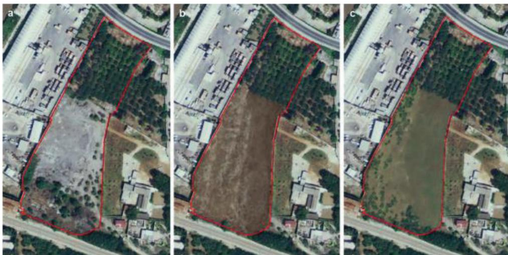
**Fig. 4** – Planimetria dello stato dei luoghi prima dei lavori (a) e nella simulazione delle fasi successive agli interventi di ripristino morfologico (b) e di rinaturalizzazione (c).
