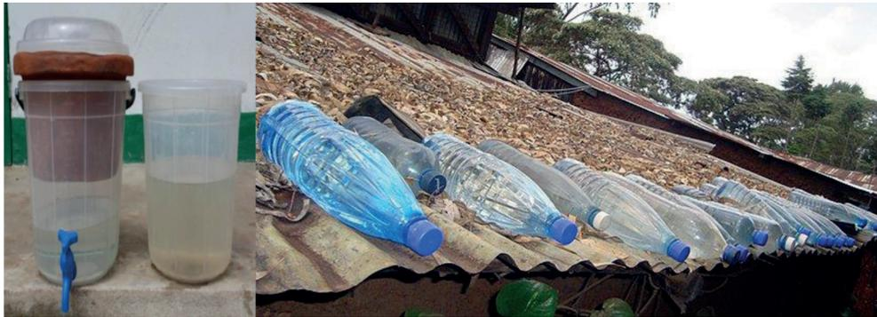
**Fig. 2** – Sistemi per la disinfezione dell'acqua potabile mediante vaso in terracotta (sx) e radiazione solare (dx)
