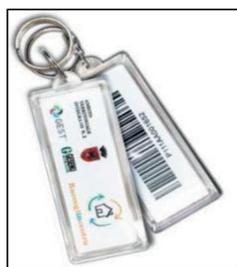
Fig. 5 – Trasponder portatile tipo portachiavi
