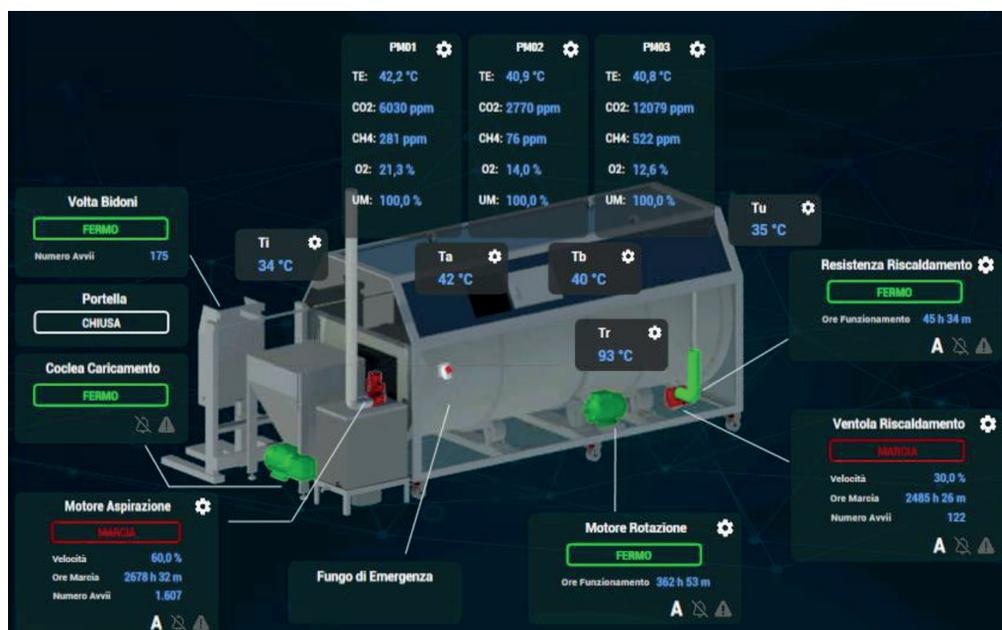
Fig. 2 – Esempio dashboard di telecontrollo SCADA Acea Smart Comp
