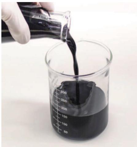
**Fig. 1.** – PetroFix, carbone attivo colloidale iniettabile.
