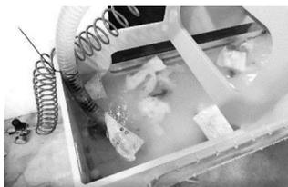
**Fig. 9** – Test sulla movimentazione di fluidi con solidi sospesi lunghi e filamentosi
