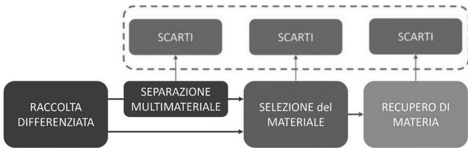
**Fig. 3** – Schema di flusso ideale del recupero dei rifiuti separati attraverso la raccolta differenziata che, dopo le operazioni di selezione e riciclo, generano una quantità di materie prime a recupero di materia inferiori al materiale raccolto per effetto degli scarti generati in ogni fase di trattamento (Bellan e Grosso, 2020).
