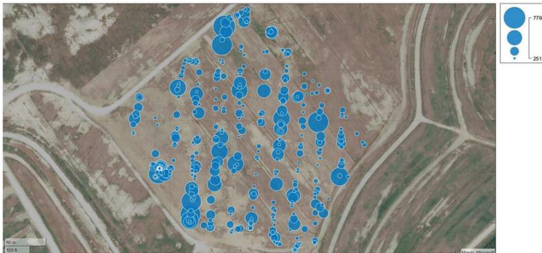
**Fig. 2** – Rappresentazione grafica puntuale degli hotspot emissivi rilevati da drone
