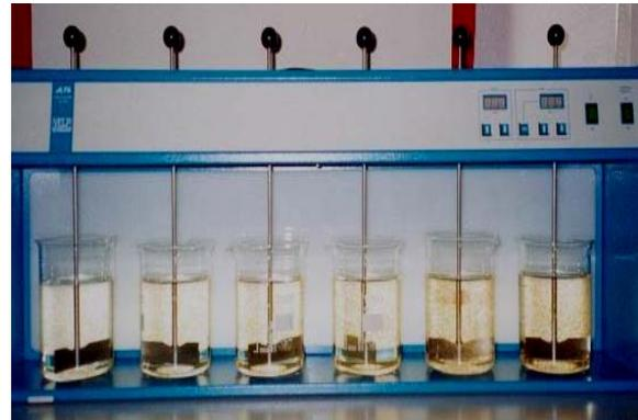
Fig. 1. Jar test apparatus
